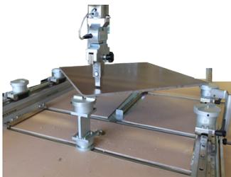
TEST PROVA IN DIAGONALE A 70 MM AL BORDO DEL PANNELLO
