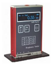
CODE..... GT2625 MODEL . . . . . . ROUGHNESS TESTER RIPRODUCIBILITY . . . . . '≤ ± 15% RESOLUTION . . . . . . . . . . 0,05 μm EXTERNAL DIMENSION . . . 106x70x24 mm VOLTAGE . . . . . . . . . . . . . . . . . Batteria ricaricabile WEIGHT . . . . . . . . . . . . . . . . . . 200 g
